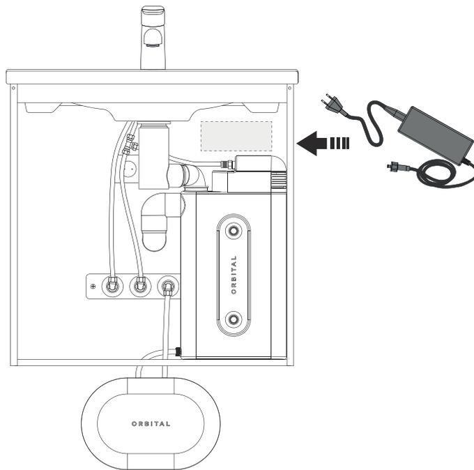
2. Schließen Sie das Netzteil an den Tank an.
