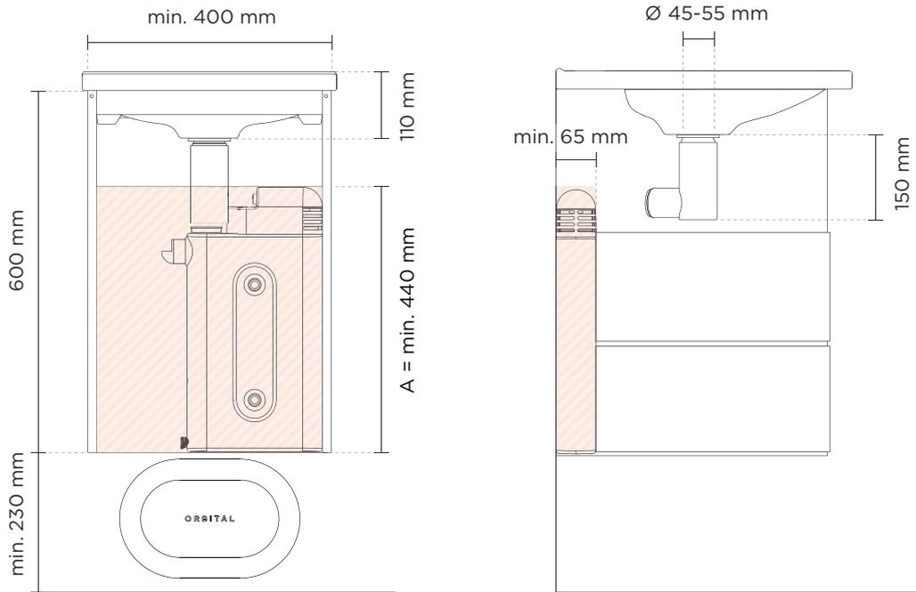
*A = Fläche mit offener Fläche zur Montage der wandmontierten Bauteile.*
