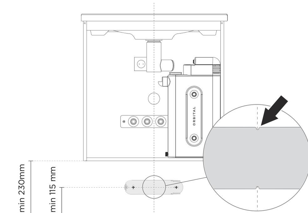
2. Setzen Sie die Dübel ein und schrauben Sie die Wandhalterung fest.
