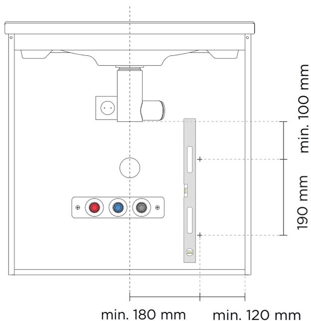
3. Setzen Sie die Dübel, Schrauben und die langen Abstandshalter ein.
