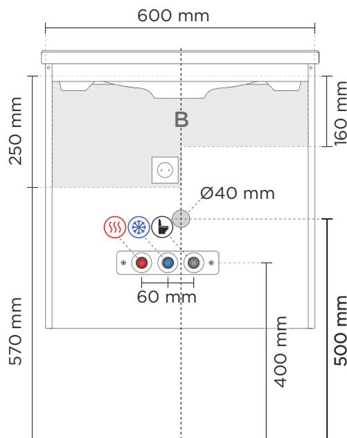
2. Installieren Sie den Anschluss an die Toilettenspüle. Passen Sie die Rohrleitung entsprechend dem Installationsszenario an. Der Abstand zwischen Pumpe und WC-Zisterne darf maximal 6 Meter betragen.
