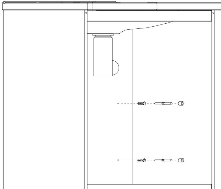
4. Befestigen Sie den Tank. Fügen Sie die dünnen Unterlegscheiben hinzu und sichern Sie sie mit den Muttern.
