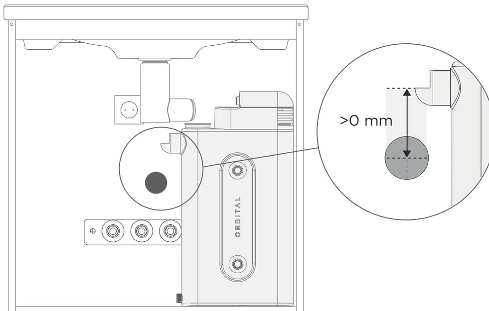
2. Bohrungen für den Tankbefestigungssatz vorbohren.
