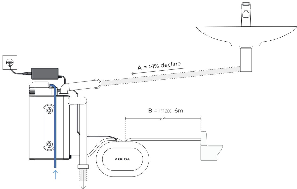
**A.** Der Bodenventilauslass muss höher als der Einlass am Tank platziert werden (mindestens 1 % Neigung).
